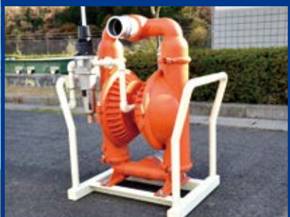
エアハート工法用 ダイヤフラムポンプ (高さ800×幅500mm)
